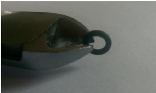
Zunächst schneidet man den O-Ring an **einer** Stelle durch, ohne ihn zu teilen (Bild li.) Nun nimmt man einen Schlitzschraubendreher, stülpt den O-Ring über dessen Klinge bis man ihn wie auf Bild re. gezeigt mit dem Zeigefinger festhalten kann.
