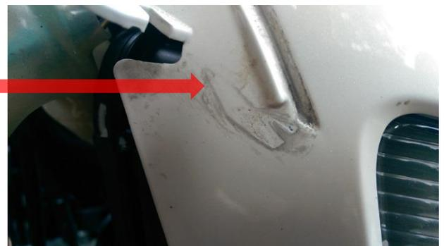
Diese und weitere Scheuerstellen müssen nun mit einem geeigneten Klebeband abgeklebt werden. Im hier vorliegenden Fall wurde Aluminium-Bitumenklebeband aus dem Dachdeckerbereich verwendet (Im Baumarkt für ca. 10€). Dieses Band hat den Vorteil, dass sich die Berührungspunkte der Verkleidungskomponenten etwas in das Band hineindrücken und so ein zusätzlicher Formschluss entsteht.
