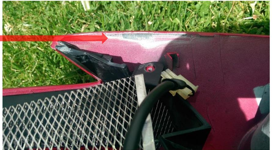
An diesen Bildern erkennt man wo die Seitenverkleidung an der **Scheinwerferverkleidung** scheuerte.
