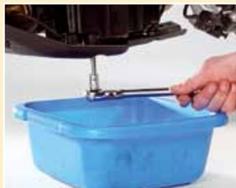
O'zapft is: Ölablassschraube mit passendem Schlüssel lösen
