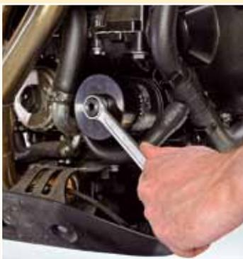
Zuerst den Ölfilter mit passendem Schlüssel lockern...
