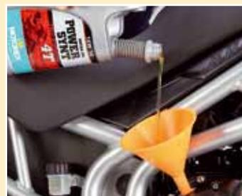
Lebenssaft: Vorgegebene Ölmenge einfüllen, Motorkurzlaufen lassen
