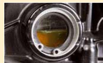
Bullauge: Wenn der Ölfilter sich vollgesogen hat, den Ölstand checken. Nachkontrolle bei betriebswarmen Motor wird empfohlen
