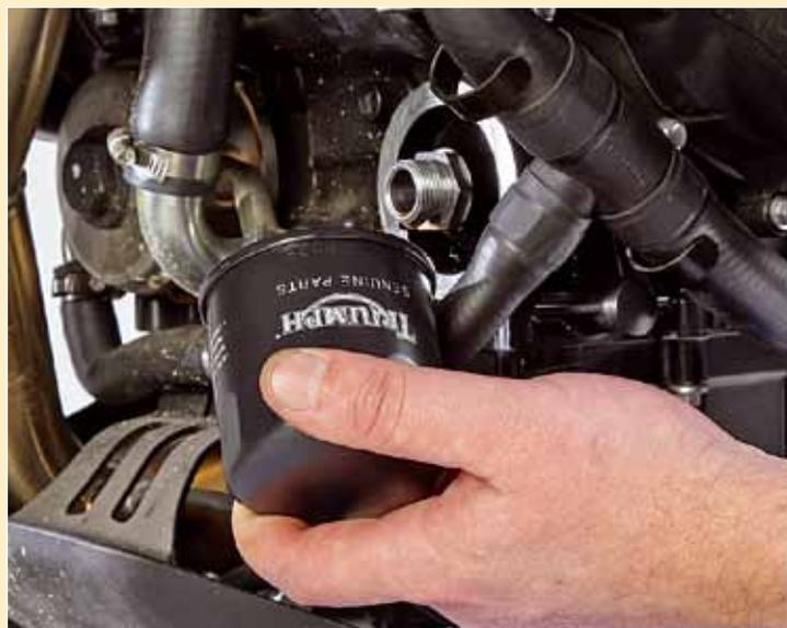
Fertigmachen zum Finale: Dichtfläche reinigen und Filter anschrauben
