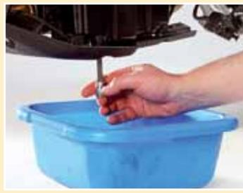
Gleichkommt's: Schrauberausdrehen und alten Dichtring entfernen
