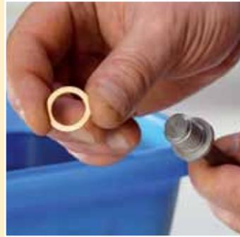
Zweiter Gang: Nach der Pause frischen Dichtring aufsetzen
