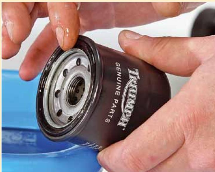
Jetzt wird's glitschig: Dichtring des Filters leicht einölen
