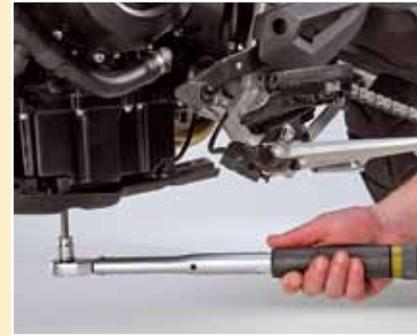
Passgenau: Schraube mit passendem Drehmoment anziehen
