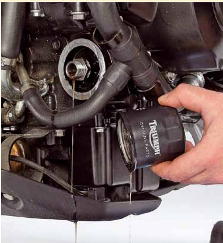
Zeit für eine kurze Pause: Ölfilterstutzen und Ablassbohrung mindestens zehn Minuten ausbluten lassen
